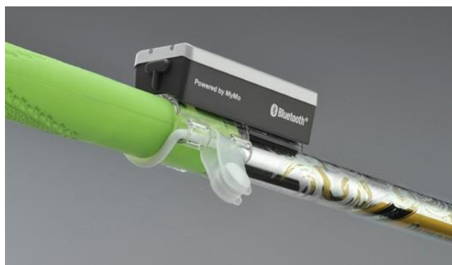
〈本特許の構造を有するスイングセンサー例〉
