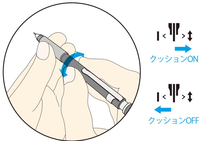
グリップを押し、ボディを回転させることでクッション（セーフティスライド機構）のON・OFFを切り替えることができます。
