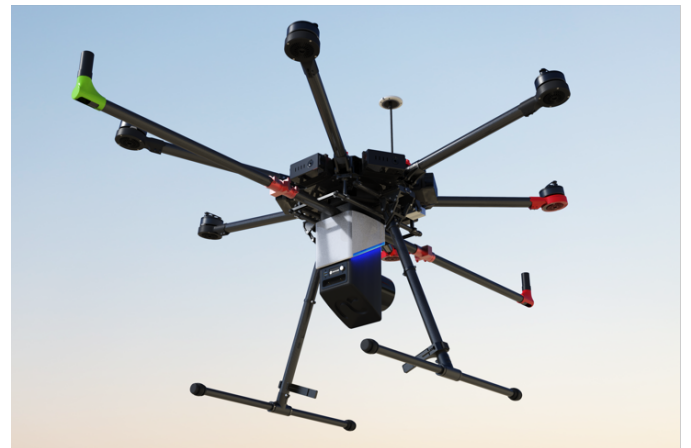
DJI製 Matrice600 Pro搭載「NextCore RN50」
