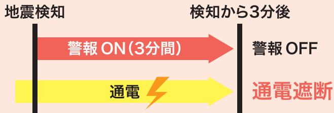
地震探知後3分以内に停電が発生した場合 → 復電直後に主幹漏電ブレーカーを自動遮断します。
